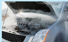
冷却不良によるオーバーヒート
